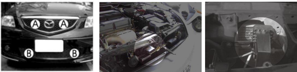
A,B – przykładowe miejsca montażu sensora, zalecany sposób montażu w pozycji poziomej - jak na środkowym zdjęciu
